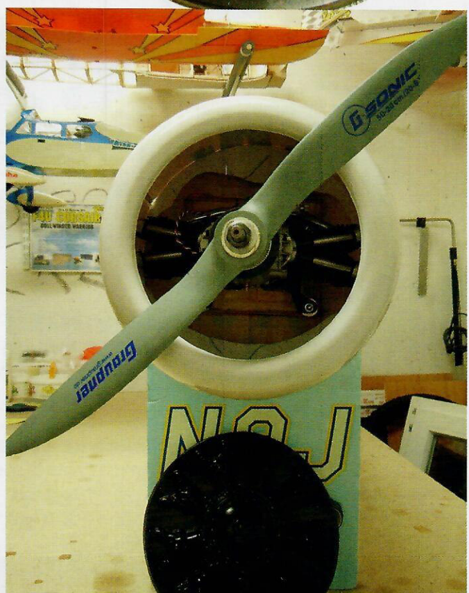
Gott om plats nu men tändsystem skall också in i kåpan och avgasrör.
