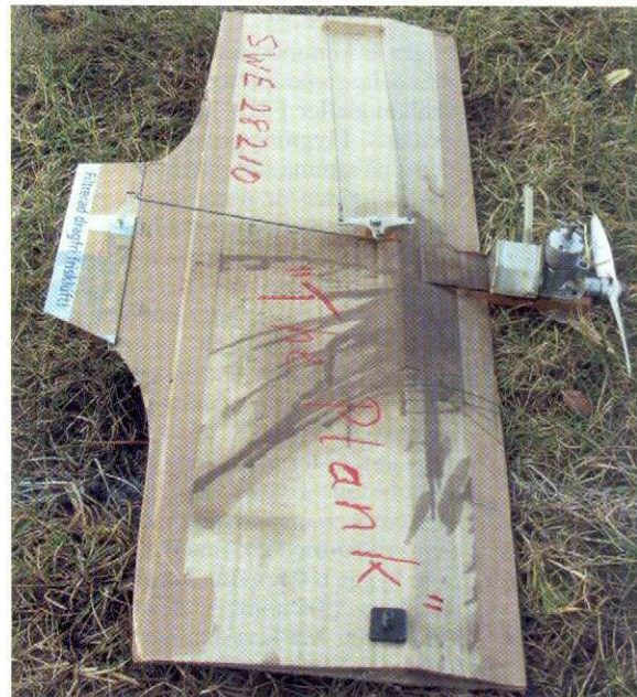
Som synes kan man bygga en modell av vad som helst, i detta fall wellpapp och ett par furulister. Vingprofilen är väl inte den mest aerodynamiska, men spelar roll, den flyger ju!
