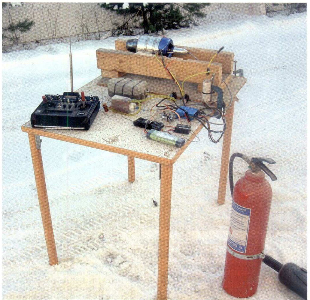
På bilden visas allt som behövs för att provköra en modelljetturbin. Observera brandsläckaren.
