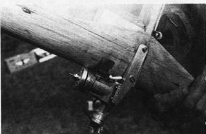
Närbild på en av Dorochenkos specialmotorer för combat. Motorerna är genomgående mycket lätta, liksom modellerna. OBS Tanken är fäste för roderoket.
