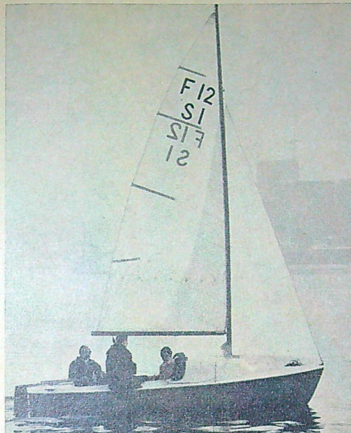
F 12 Fajak kommer från IW-varvet, är byggd i plast och mäter 5,10x1,90 m och för 12 m 2 segel. Ruff ger liggutrymme för två. Kölen är ny och patent-skyddad, ett slags centerbordliknande nedsänkbar fenköl som kan belastas med önskad vikt i form av blytackor. Pris 8 225:—.
