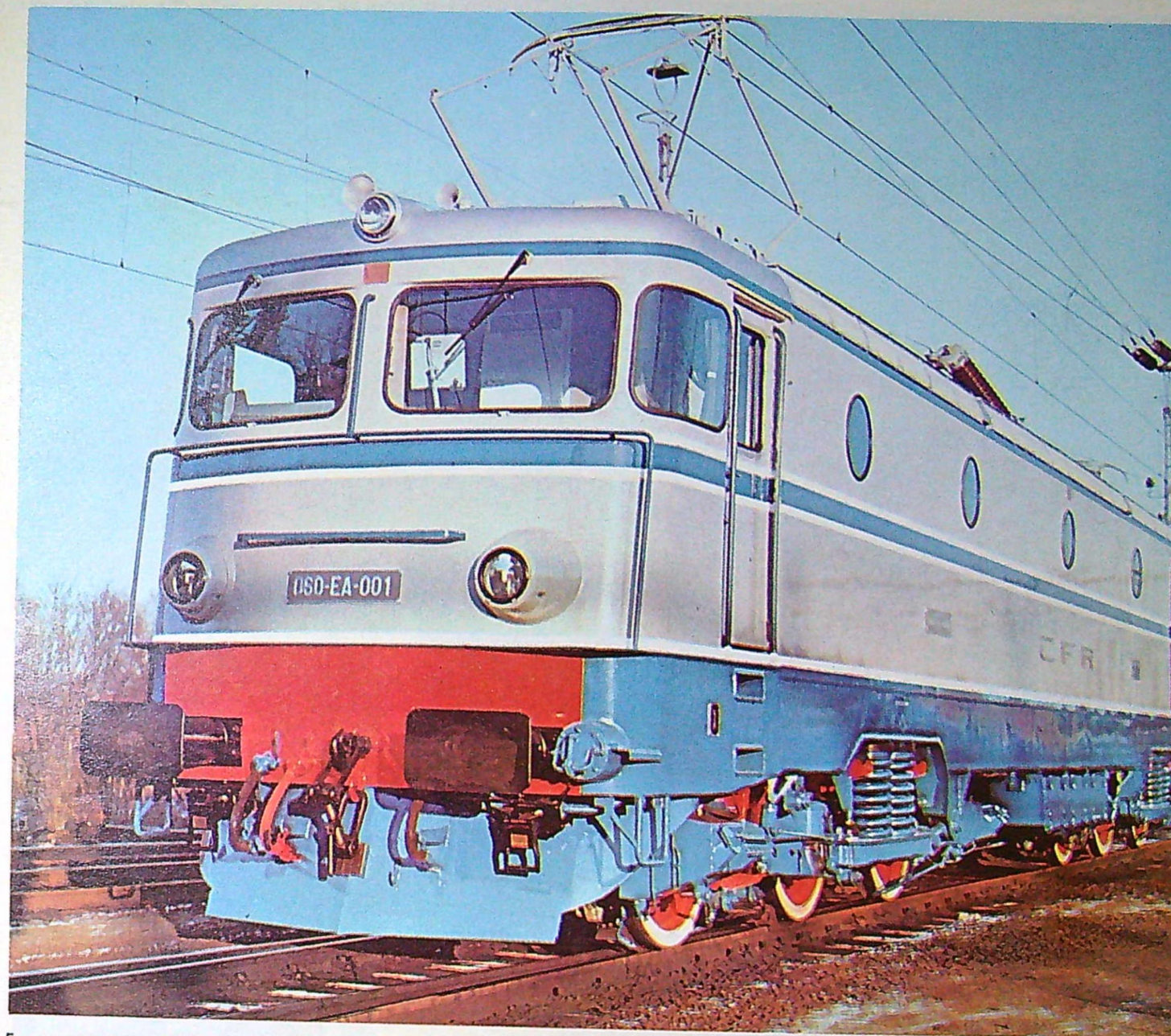
En snygg exportvara. Loket mäter 3,0x19,8 m och har en hjul diameter på 1,25 m. Det väger 120 ton, axellast 20 Mp. Det har sex banmotorer och den maximala startdragkraften är hela 42 Mp vid en timeffekt på 5 400 kW och en transformator effekt på 5 790 kVA. Normal topphastighet är 120 km/tim, ett lok har annan utväxling och gör 160 km/tim.
