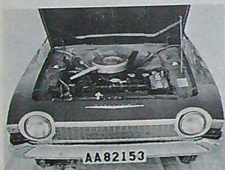
Det överskådliga motorrummet innehåller en intressant nyhet: En V4 på två liter, snabb och stark. Motorn är kortare och lägre än en rak fyra, och typen har nog kommit för att stanna.
