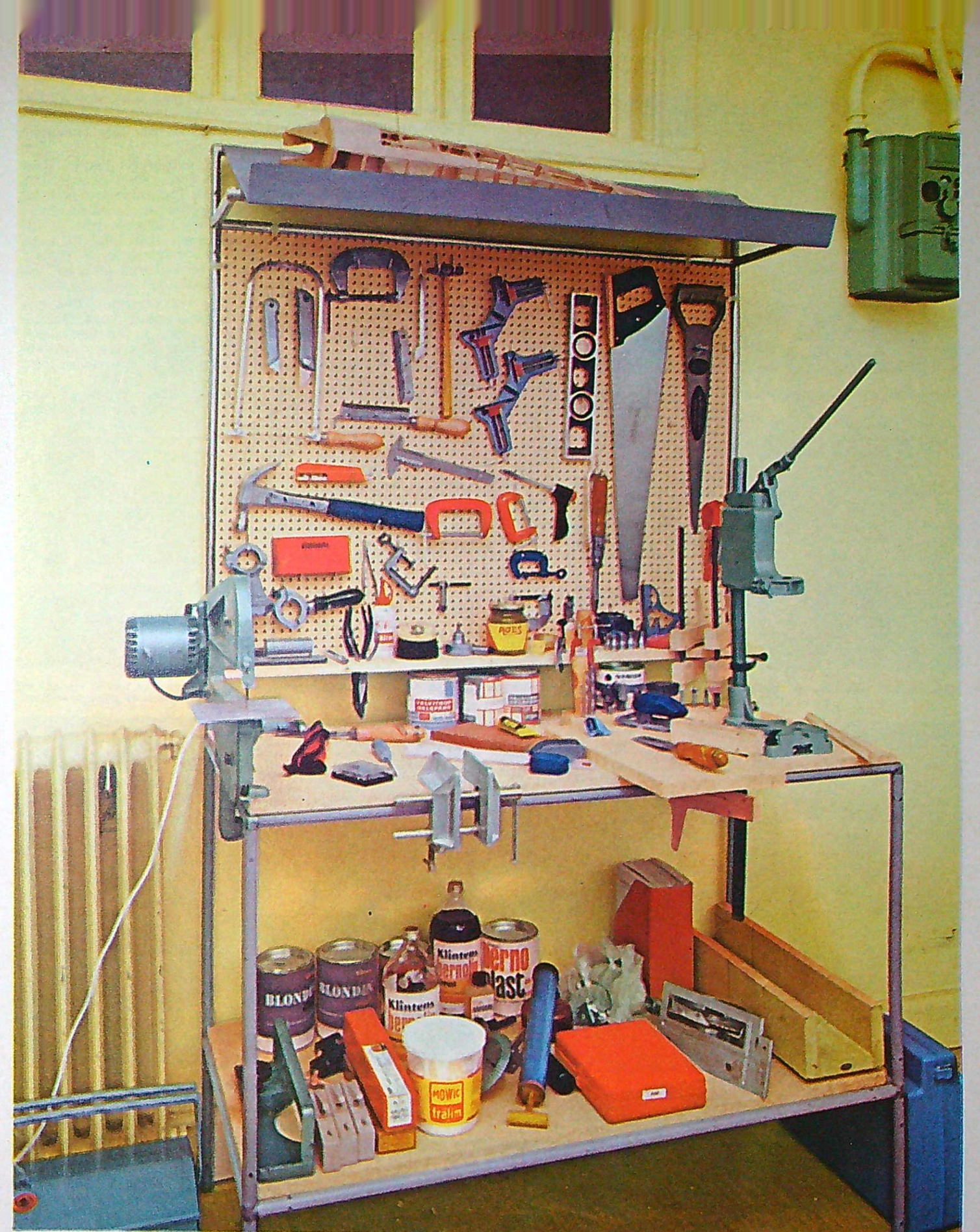
Även en och annan hobbyist och "hemmahantverkare" kan ha bruk för en bänk eller avläggningsplats byggd med något byggsystem. Här en bänk med rygg och snedhylla byggd enbart med Abstractas 13 mm-system. Önskar man en kraftigare bänk är det lämpligare med fyrkantssystemet.
