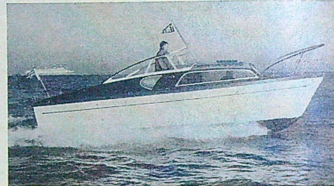
Fairley Huntress 26 visades för första gången på båtmässan. Det är en 7,9 m lång kabinbåt, som ritats av Ray Hunt. Liksom övriga Fairleybåtar är skrovet byggt av diagonalt lagda fanerremor, dvs skrovet är s a s utfört i formlagd plywood. Metoden ger ett starkt och lätt skrov.
