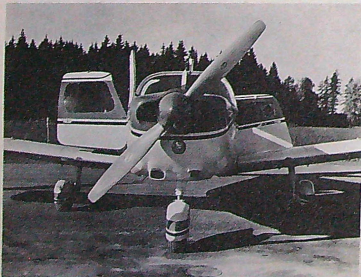
Den bakre instigningsdörren, som sitter väl bakom vänstra vingen, kan enkelt lossgöras och planet kan flygas utan denna. Flint för fallskärmshoppare.
