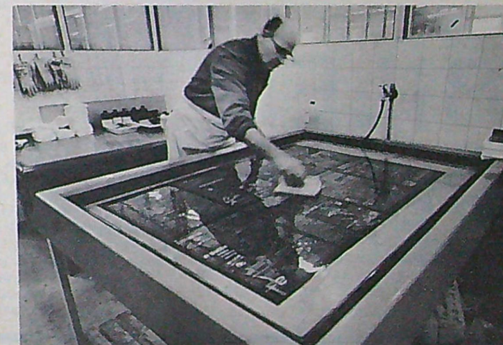
Av ljuset (och värmen) härddas de belysta skikttytorna. De icke belysta ytorna etsas bort och de frilagda plåttytorna behandlas med lack, som är det färgbärande, "fettvänliga" elementet på den färdiga plåten. De obehandlade vat-tenvänliga plåttytorna befrias så från det härddade skiktet.
