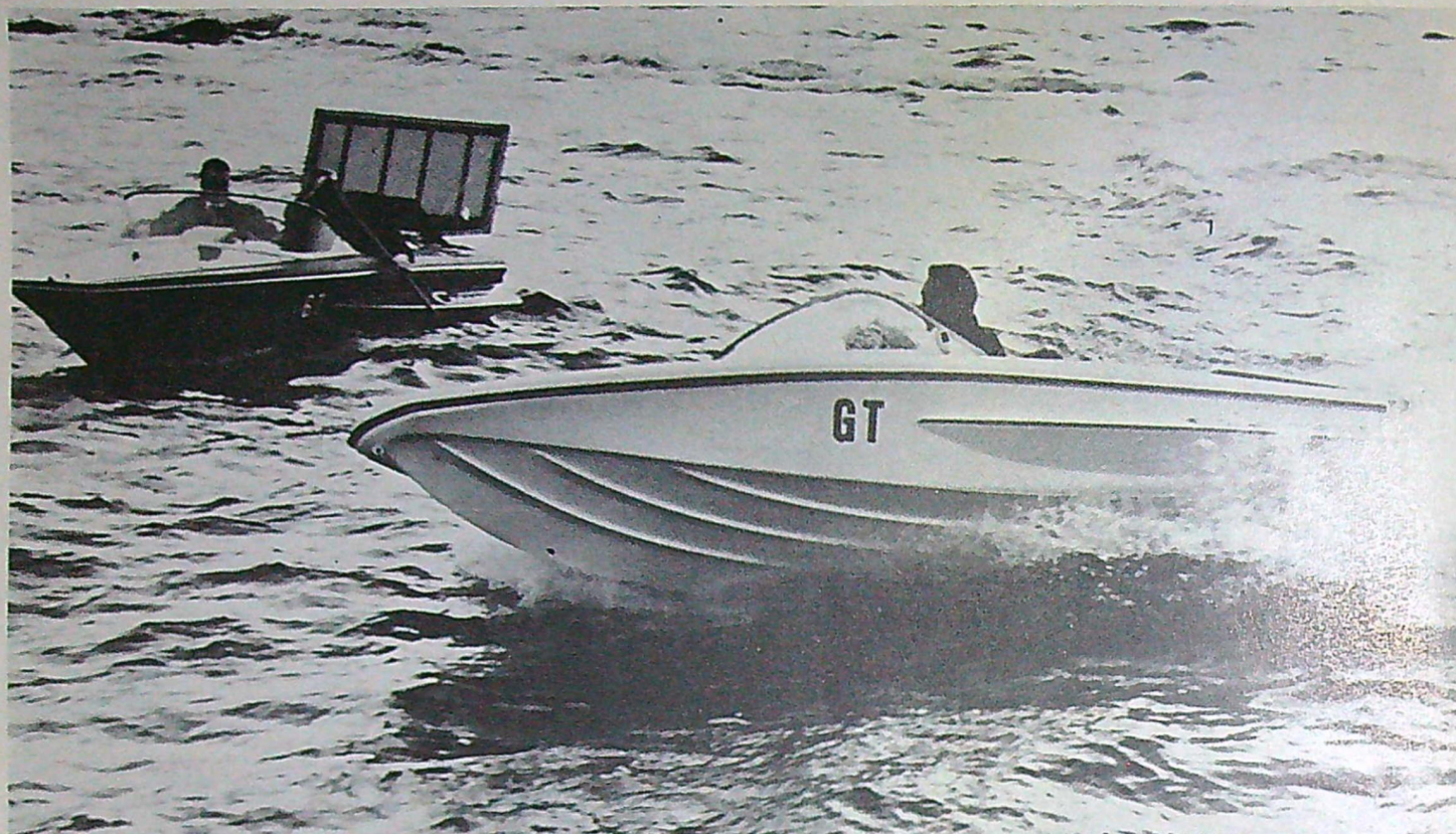
En av årets intressantaste båtnyheter är Weedo GT. Det är en förbättrad version av den Weedo 14 som kom totaltvåa i 1965 års Roslagslopp. Båten har djup V-botten av Bertram-typ — har sex "lyftsteg" — och är 4,20 m lång och 1,85 m bred. Inredningen är påkostad med bl a Volvo Amazon-stolar. Weedo GT kostar med nya Crescent Inu 45 och 90 l tank etc ca 13 000:—.
