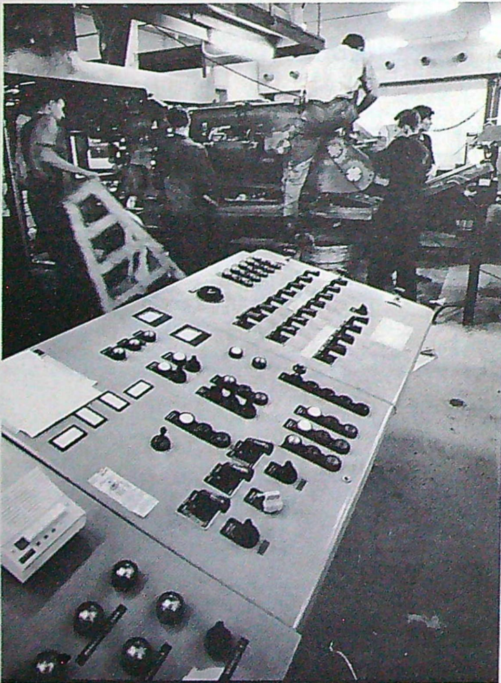
Nära tre miljoner kronor kostar STB:s GMA-Levey Web offsetrotationspress. Den är nära 25 meter lång och 5 meter hög. Kontrollbordet på bilden nedan ger en uppfattning om hur komplicerad en tryckpress av det här formatet är.
