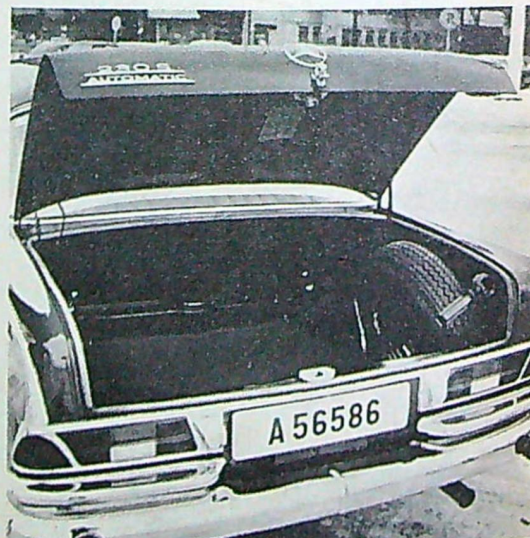
Bagageutrymmet talar för sig självt. Det bör räcka för de flesta. Bakom nummerplåten sitter tanklocket.
