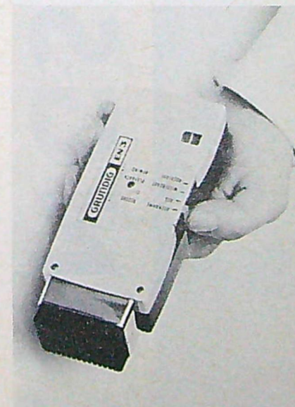
Grundig EN 3 har en kombinerad högtalare och mikrofon (burken på änden). Den kan utbytas mot hörtelefon. Inspejning, stopp, återgivning och snabb återspolning ställs in med knappen på sidan.
