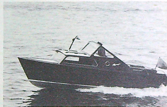
Mysingen 6 är en mahognybyggd kabinbåt med måtten 7,05x2,50 m. Den är försedd med inu-aggregat Volvo/Penta Aquamatic på 110 hk, har två kojplatser, pentry och garderobsutrymmen.
