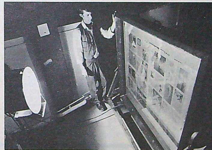
De monterade sidorna läggs mot en ljuskänslig plåt som sedan exponeras precis som vid vanlig kontaktkopiering, med undantag för att man här arbetar från positivfilmer. För att uppnå bästa möjliga kontakt mellan positiv och plåt placeras de i en vakuumram.
