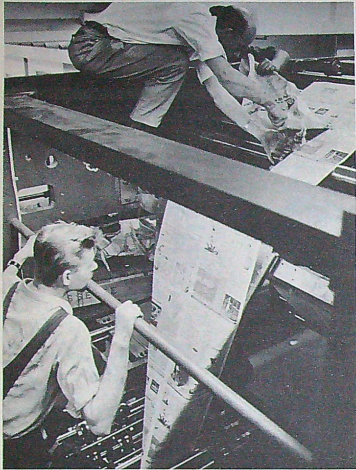
Nära tre miljoner kronor kostar STB:s GMA-Levey Web offsetrotationspress. Den är nära 25 meter lång och 5 meter hög. Kontrollbordet på bilden nedan ger en uppfattning om hur komplicerad en tryckpress av det här formatet är.
