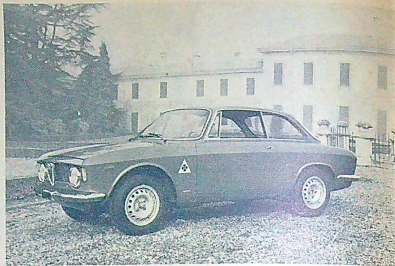
Alfa Romeo GTA är ett tävlingsutförande av GT-vagnen på 1,6 liter med lättmetallkaross och en motor på 129 hk SAE. Vikten är bara 730 kg. "Alfa Corse"-treklövern på sidan satt en gång i tiden på Alfa Romeos fabriksvagnar.
