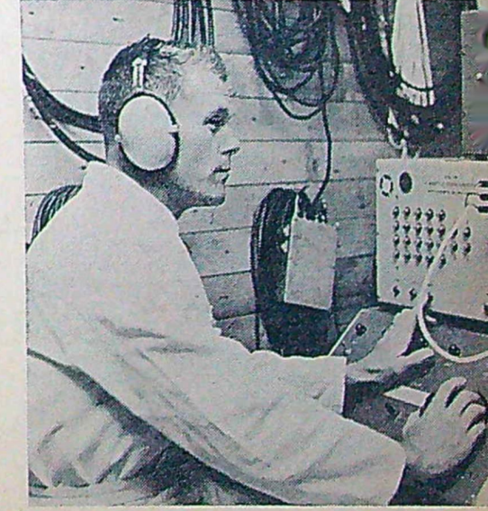
... till den som sitter vid manöverpanelen och utlöser sprängladdningen när också kamerans roterande spegel uppnått det föreskrivna varvtalet. Och några mikrosekunder senare öppnas slutaren.
