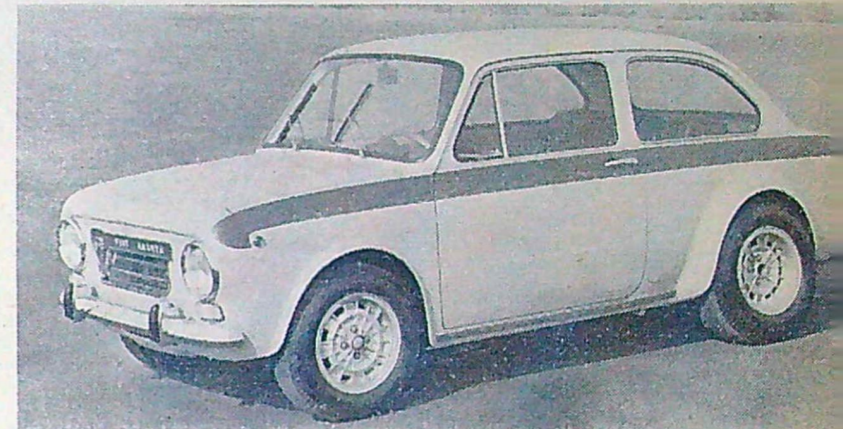
Bakom denna oskyldiga uppsyn döljer sig en veritabel raket. Endast hjulen med elektronfjälar och racerdäck antyder att det är något extra med Abarth 1600 OT. En till 154 hk trimmad motor ger 220 km/tim i toppfart åt den 760 kg tunga vagnen!
