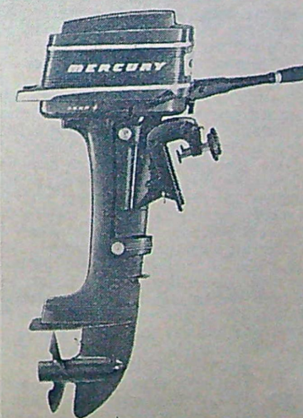
Den minsta Mercury-motorn i 1965 års serie är Merc 39 på 3,9 hk. Den har komplett växelsystem, gummidämpning och separat bränsletank.
