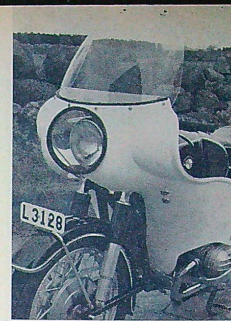
På denna maskin har man bibehållit originalstrålkastaren och satt in en bit plexiglas i kåpan.
