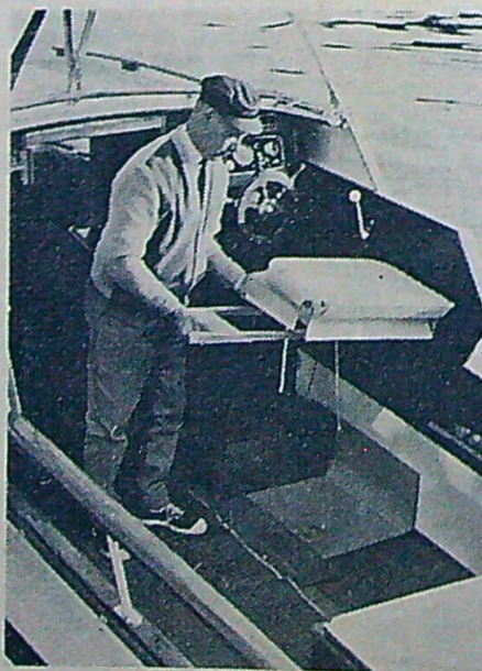
Inredningen är väl genomtänkt. Förarstolen är t ex hopfällbar, något som kan vara en fördel när man önskar manövrera båten stående.
