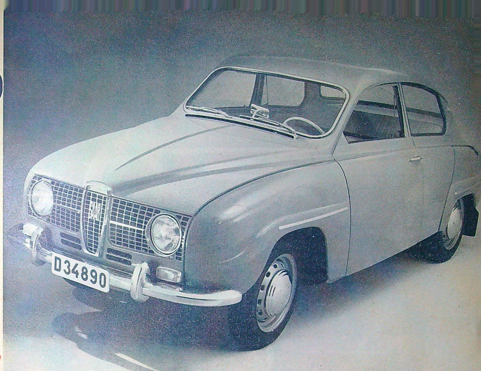
SAAB har fått en "kontinental" grill som medgivit en mera sluttande motorhuv, varigenom den tidigare dåliga sikten avsevärt förbättrats. Den nya frontens sträma utformning vill inte riktigt smälta ihop med vagnens särpräglade kurvatur.
