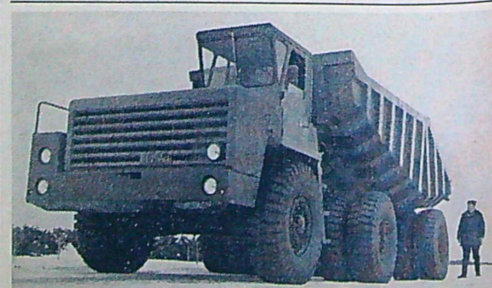
Bilen på bilden ovan tillverkas i Ryssland. Den lastar 65 ton och väger 27 ton. Fabriken är Dumper Belaz-540. Byggs i olika modeller. Detta är den minsta.
