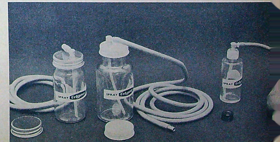
Bilden visar tre av de fyra Celspray-sprutorna. De stora bör drivas med en vanlig fotpump för bil eller motorcykel. Det blir för ansträngande att spruta så mycket färg med handblåsa.
