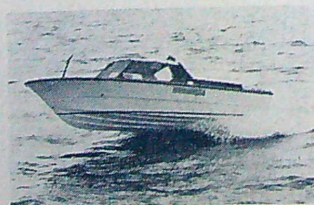
Bottenstegen syns tydligt på denna bild. Havsrörnen är utförd i ett kraftigt dimensionerat glasfiberlaminat och skrovet torde tåla åtskilligt.
