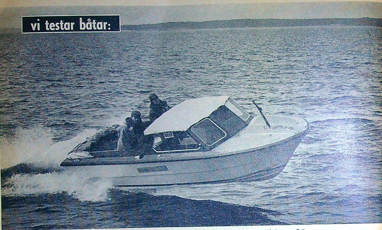
Havsrörnen har modern bottenform med djup V-botten med långgående steg av Bertraminspirerad typ. Denna båt byggs av Bothniplast i Robertfors och det var en sådan båt som placerade sig på första plats i Roslagsloppet's 'havsklass'.
