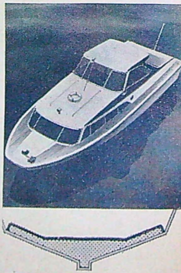
Selco har byggt en 27 fot lång kabin-kryssare i glasfiberarmerad plast. Båten har förses med dubbel botten och räkna som osänkbar.
