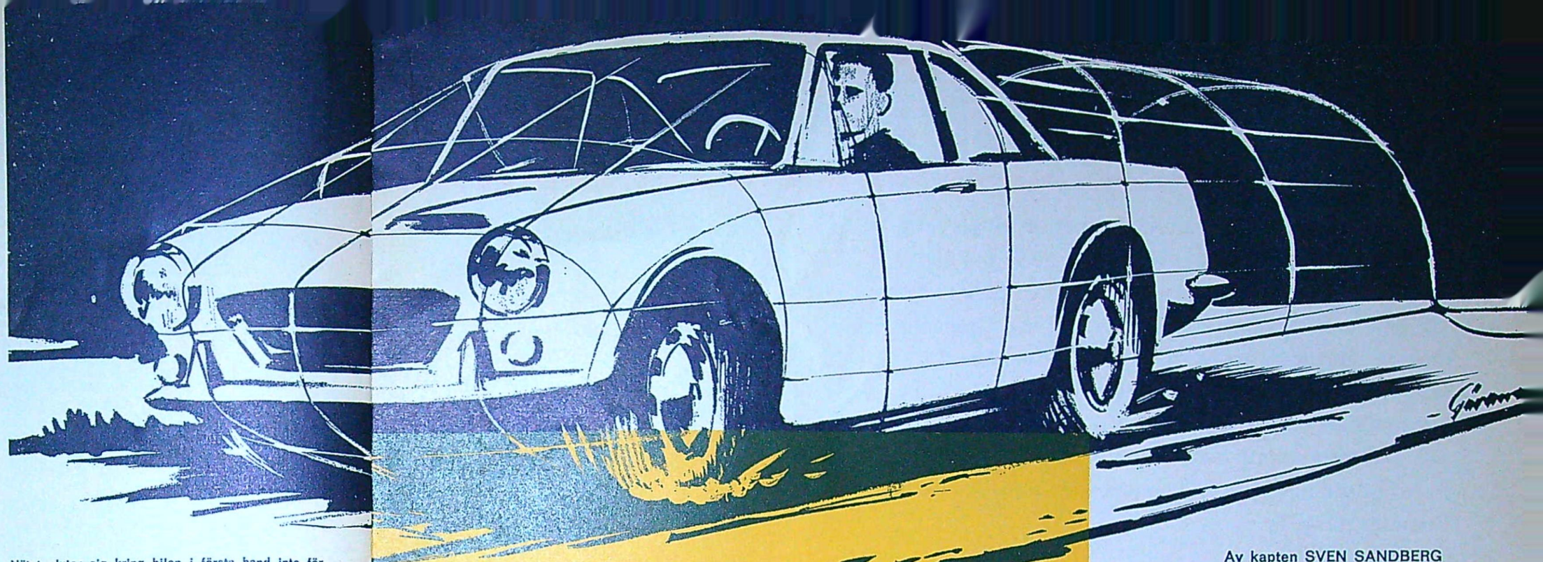
Nätet sluter sig kring bilen i första hand inte för att hindra de åkande att komma ut, utan för att bromskraften skall angripa strax bakom bilens tyngdpunkt, vilket förhindrar att bilen välts.
