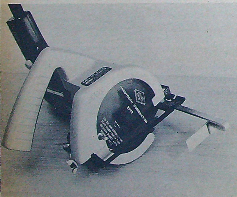
Trots lagerglapp och ett mindre lyckat klyvanhåll fungerar handcirkelsågen tillfredsställande. Sågklingans diameter är 125 mm och priset för tillsatsen 89 kr.
