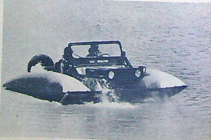
I USA håller man som bäst på att testa ett nytt sätt att forsla fordon över vattendrag. Ett par uppblåsbara plastkuddar monteras på fordonets båda sidor och dessa håller vagnen flytande. Som drivkraft fungerar bilens hjul.
