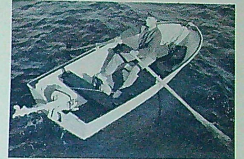
20 Monarita tillverkas av Monark och har konstruerats av Harry Becker. Denna 4 m långa plastbåt lämpar sig för motorer från 3 till 18 hk.
