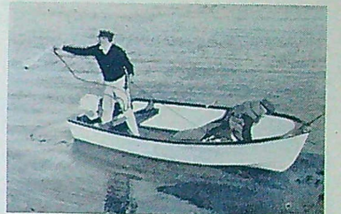
21 Monarks 11-fotsbåt är 3,3 m lång och gör 17 knop med 10 hk motor och två personer ombord. Båten väger ca 80 kg. Pris 1 250 kronor.
