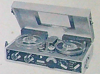
Stellavox är en helt transistoriserad bandspelare för inspelning t. ex. i skog och mark. Den fyller mycket höga krav — priset är 3 300 kr.
