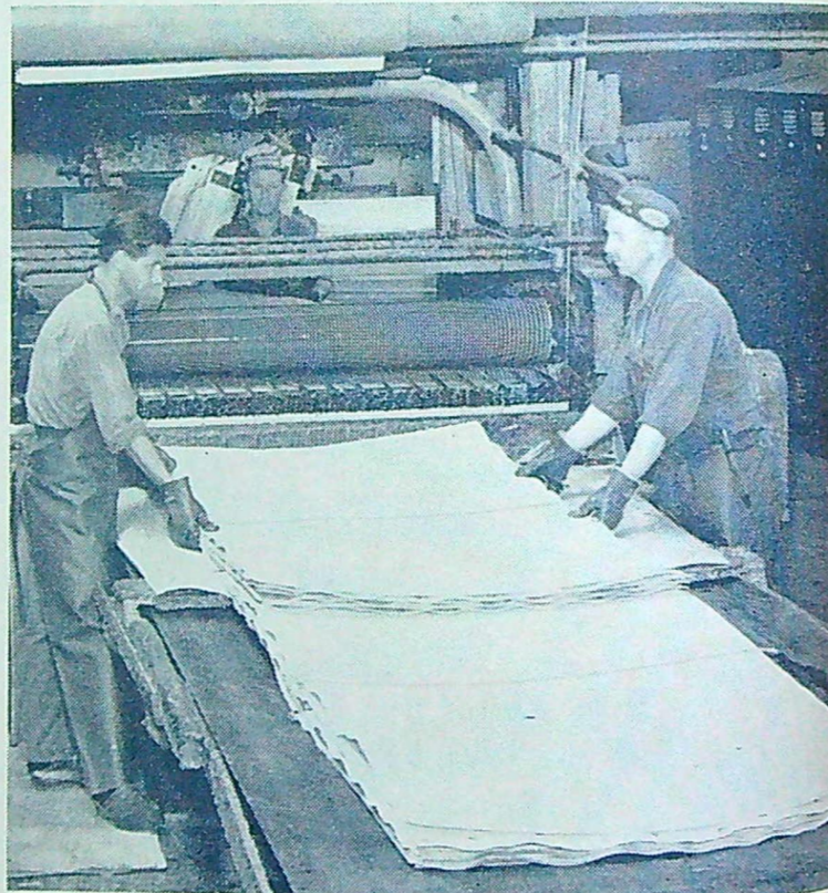
Tillverkningen av båtplywood kräver större noggrannhet än vid andra plywoodkvaliteter. Fanererna sorteras och man använder endast material utan kvisthål. Bilden visar en detalj av limningsarbetet. Vattenfast fenolhartslim ger en mycket stark fog, som enligt fordringarna på båtplywood tål 72 timmars kokning.
