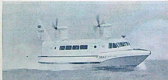
Westland SR-N2 är den största svävfarkosten hittills och har en marschfart på 60 knop (105 km/tim). Motoreffekten är inte mindre än 3260 hästkrafter.
