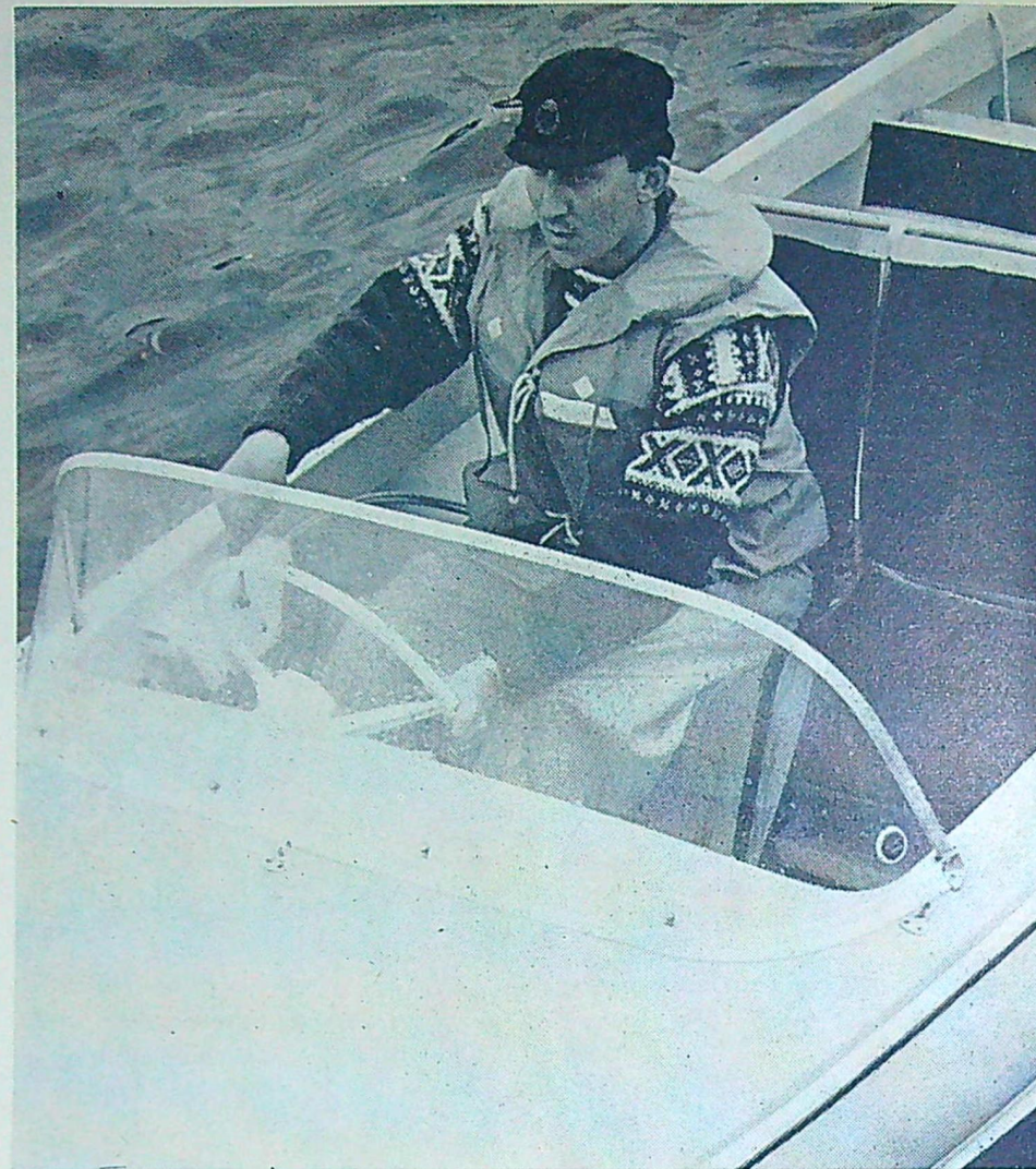
Bilsäte i båten. Teknik för Alla provade ett baksäte från en Renault R 4 i en båt av typ Lux Folka. Komforten blev åtskilliga grader bättre än man är van vid i snabba, planande båtar, speciellt vid körning genom svall.
