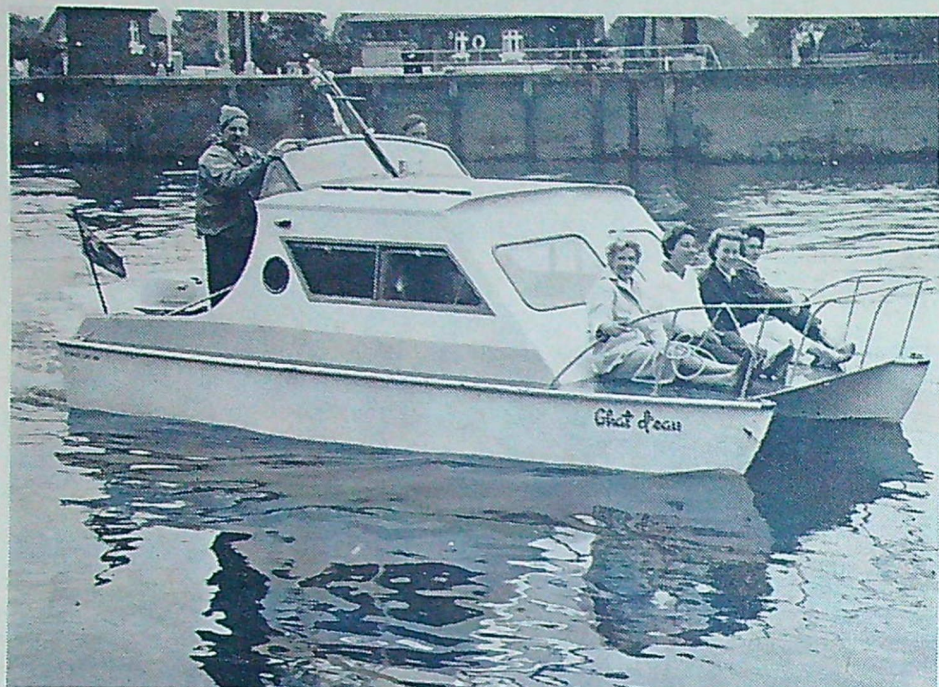
Den här typen av kabinbåt är inte vardagsmat. Det är en s. k. katamaran, som härleder sitt ursprung till Söderhavet. En utbordsmotor på 18 hk ger båten en fart på ca 12 knop. Den är tillverkad i England.
