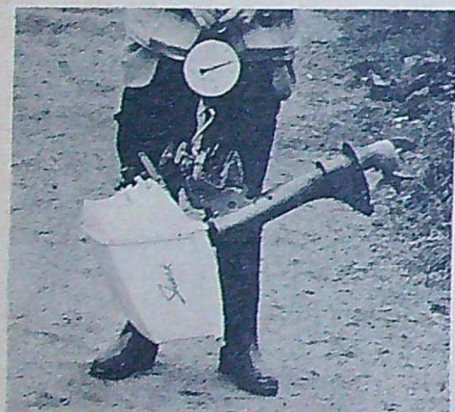
West Bend Special har en slagvolym av 196 cc och utvecklar 7,5 hk vid 4 500 varv per minut. Motorn har gasreglage och växelmechanism på framsidan, men saknar backslag. Vikt 21 kg, pris 1 520.
