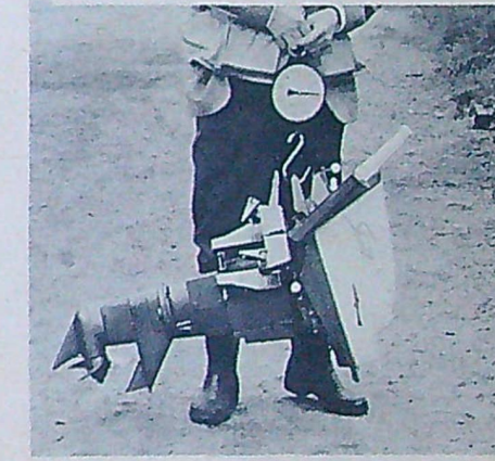
West Bend Silver Shark 12 är med knapp marginal tyngst av de sex, men också den starkaste. De 12 "hästarna" utvecklas ur 291 cc vid 4 000 v/min. Vikten är 31 kg, priset för motorn 2 235 kr.
