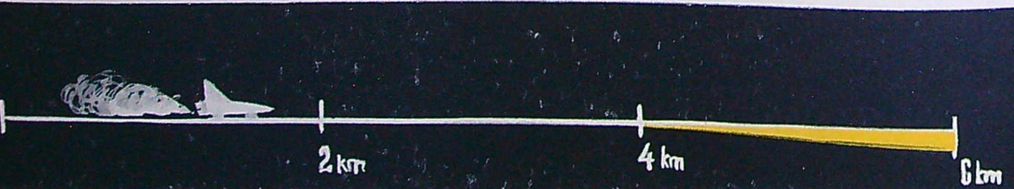
En schematisk bild av Edwards-basens testbana. Denna är sex kilometer lång och består av en räl utan skarvar. De två sista kilometrarna löper rälsen i en vattenbassäng, som utgör bromssträcka för raket-släden. Denna kan nå en fart av bortåt 5 000 km/tim och då behövs det en effektiv broms för att få stopp på den.
