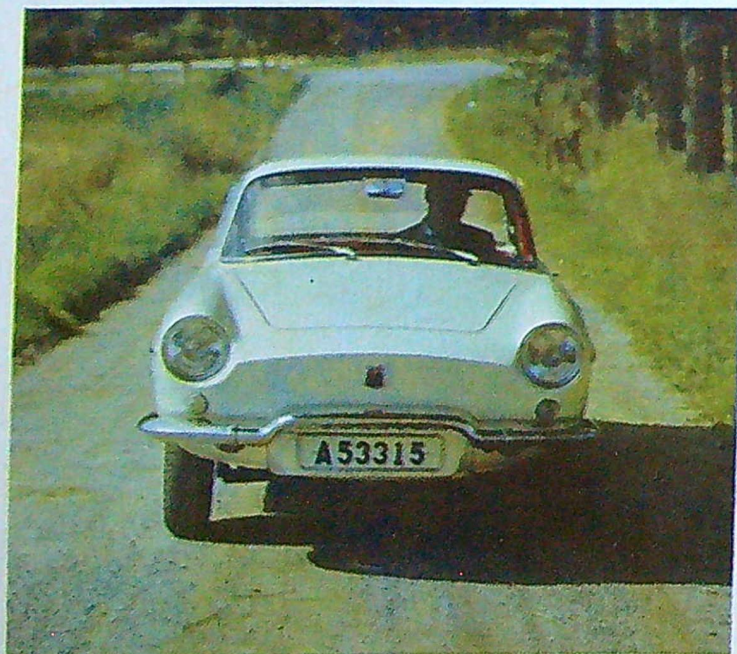
Renault Floride är en tvåsitsig vagn som är byggd på samma chassi som Renault Dauphine Gordini. Motoreffekten är 40 hk (SAE) och vagnen är
