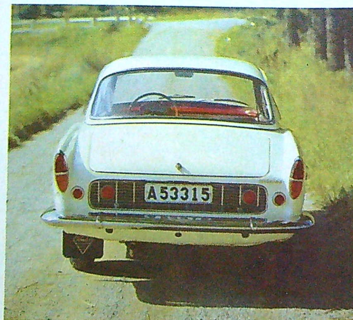
utrustad med fyrväxlad låda. Specialkarossen gör att denna vagn är ca 100 kg tyngre än Dauphine, varför dess prestanda blir ganska måttliga.
