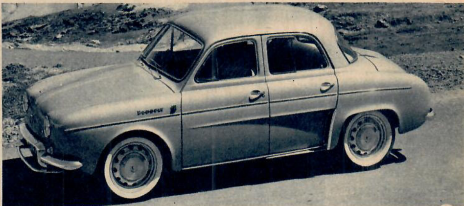
Exteriörmässigt sett bjuder Ondine inga nyheter förutom att hjulläpparna försetts med lufthål. Bilen skall endast säljas i Frankrike, är fyrväxlad, 40 eller 30 hk kan man få ur motorn
