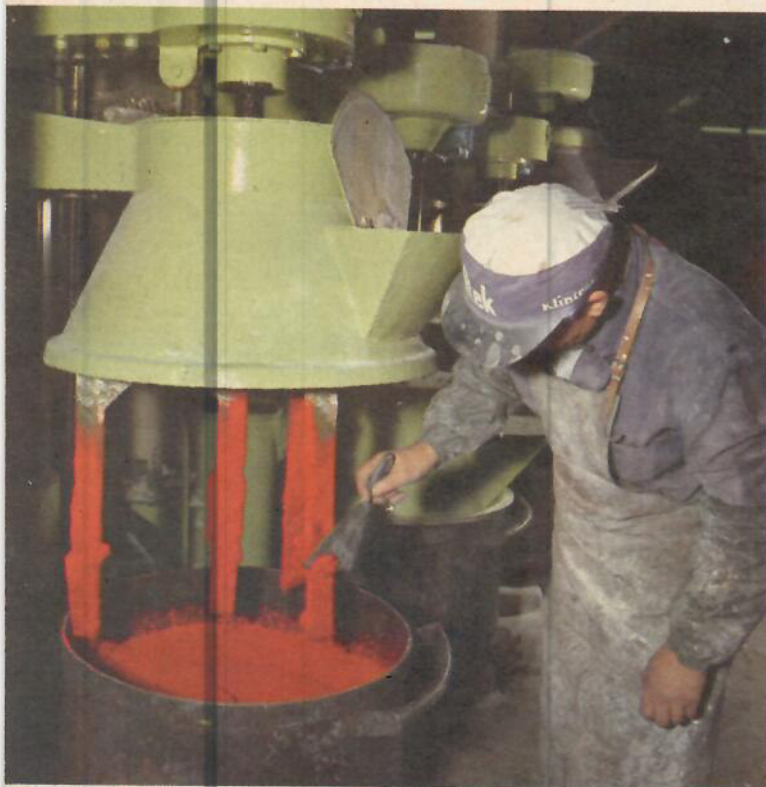
På bilden ovan har färgpigmentet gått vidare till blandningsavdelningen, där den blandas i en s.k. planetblandare. Bilden under visar tappning av färg i burkar ur en av kulkvarnarna. I denna bearbetas bindemedel och pigment av porslinskulor varvid blandning och rivning sker samtidigt.
