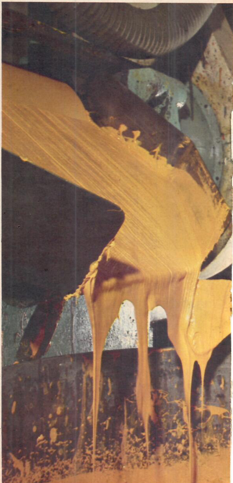
På bilden ovan har färgpigmentet gått vidare till blandningsavdelningen, där den blandas i en s.k. planetblandare. Bilden under visar tappning av färg i burkar ur en av kulkvarnarna. I denna bearbetas bindemedel och pigment av porslinskulor varvid blandning och rivning sker samtidigt.
