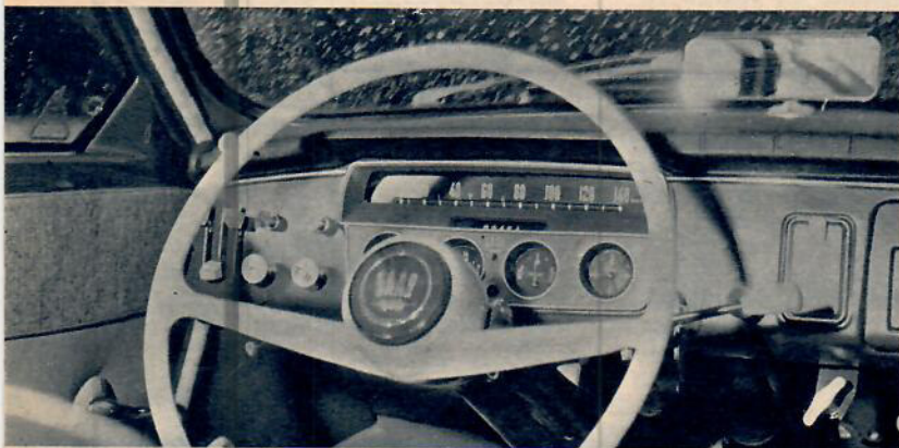
Instrumentbrädan har fått ett nytt utseende med nytt instrument och stoppad översida. Vi tycker att en signalring vore bekvämare än knappen mitt i ratten.
