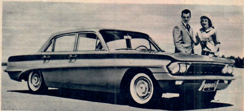
F-85 heter Oldsmobiles kompaktbil som liksom den snarlika Buick Special har en V8-motor av aluminium. Trots att motorn är på hela 3½ liter och utvecklar 155 hk väger den inte mer än knappt 150 kg.
