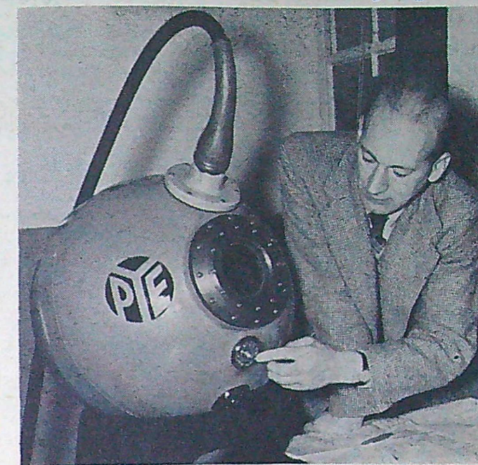
Undervattenskameran har bl. a. sockel för inkoppling av strålkastare eller högtalare.
