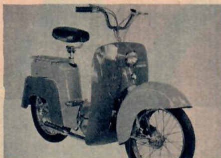
Crescent Mopedscooter bjuder åkaren mopeder- nas ekonomi och skoterns bekvämlighet. Den har en Sachsmotor med kickstart och två växlar.
