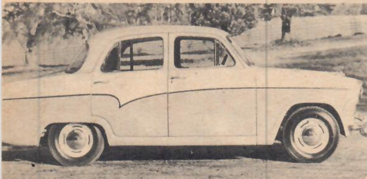
En nykomling i Austinfamiljen är den nya A 55:an. Vagnen har fått låna linjer från sin storebror A 95 och därigenom fått ett smäckrare utseende. Motorn är en 4 cyl. topp på 51 hk. Bland finesserna märks bagagelucka utan tröskel och hängande pedaler. Bilden visar De Luxe-modellen.
