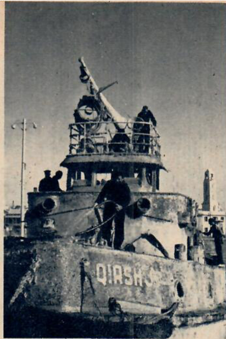
I sydliga vatten blir vraken snabbt boplatser för snäckor och alger. Bogserbåten Qirsh har just lyfts och spolats ren i Port Saida hamn.
