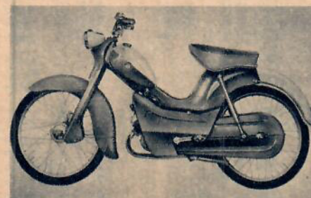
Kreidler Amazon är en nyhet för året. Allt inkapslat men ändå lättåtkomligt för service.
