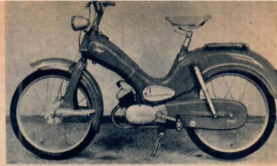
Humlan av fabrikat DKW är en av de få mopeder med tre växlar. En detalj som garanterar att man inte behöver trampa uppffärsbacken
