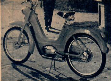
Jawa presenterar i år en helt ny moped. Bilden visar prototypen varför en del förändringar kan väntas. Helkapslad kedja är en av finesserna.
