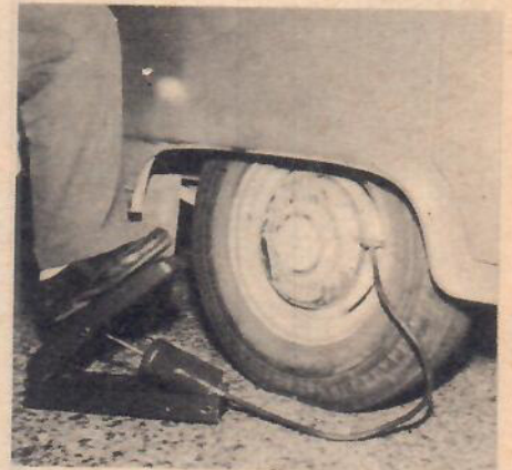
Ett gammalt hederligt tillbehör har kommit tillbaka. I verktygssatsen på Pontiac Six finns en fotpump som faktiskt fungerar utmärkt.
