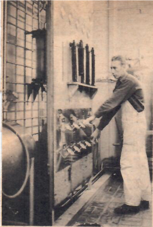
Sune Almgren övervakar vätske-vätske-extraktionen som är ett led i uranets framställning.
