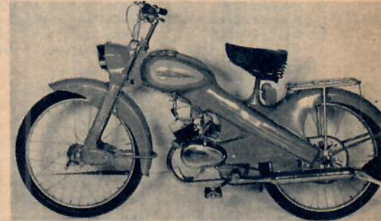
Från Bolaget Folkcyklar kommer Stafette. En robust bruksmoped utan bakhjulsfjädring men i övrigt helt modern med sin pressade plåtram.
