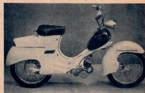
Apollo Monte Carlo har lånat en hel del drag av Månraketen kring bakhjul och fram. Drivkraften är en tysk tvåväxlad Zündapp-motor.
