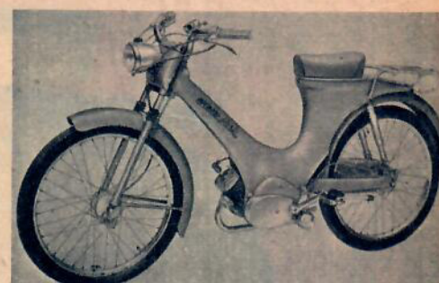
Heinkel Perle har gjuten lättmetallram och helt inkapslad kedja i oljebad. Ramkonstruktionen ger Heinkel-mopeden ett elegant utseende.
