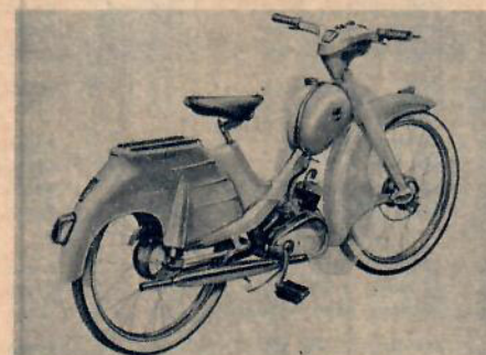
NSU-lyx, eller mopeden i frack som reklamen säger, har kraftig ram, vind- och stänkskydd o. ordentligt inkapslade hjul, plus bakhjulsfjädring.
