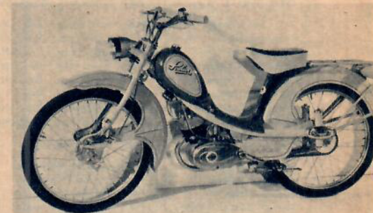
Svalan bjuder i år även en treväxlad version av sina mopeder. Motorn är en HMW med kickstart. Ordentlig fjädring på fram- och bakhjulet.
