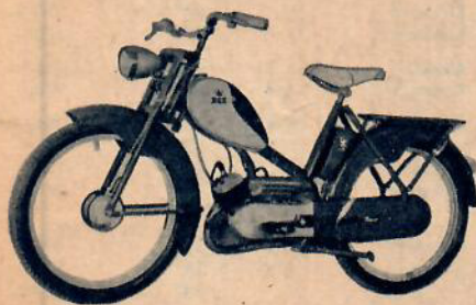
Den nya Rexoped Topper är den första svenskbyggda mopeden med helkapslad kedja. Topper kan fås 2- eller 3-växlad och har Victoriamotor.
