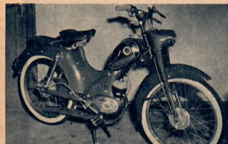
En moped med sting är denna HMW. Fram- och bakhjulsfjädring av teleskoptyp. Med styrlås.
