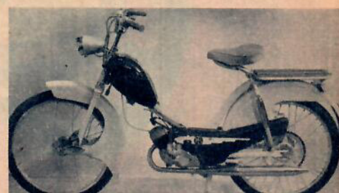
Apollo Motorette har Zündappmotor, bottenlänkfjädring fram och teleskop bak. Bruksmodell.
