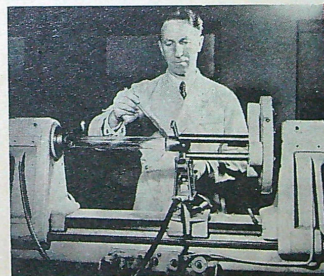
T. v.: Glastekniker L. Claesson utför en glasmetallsmältning i glassvarven.
