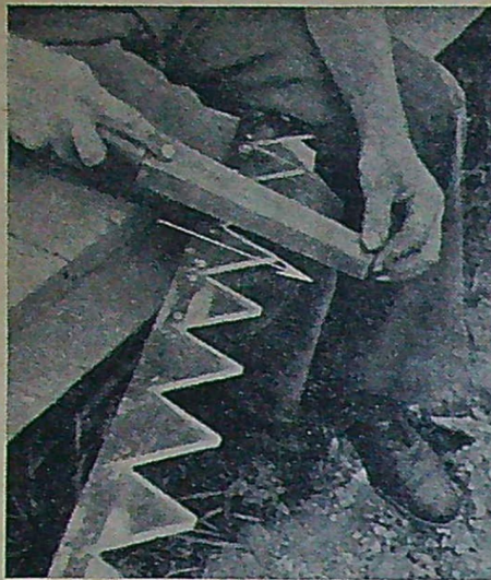
En slättermaskinskniv kan skärpas utan att tas bort. Brynet förs på sätt som bilden visar.
