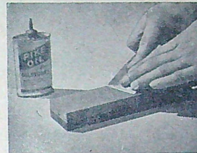
Ovan: Stålets bladvinkel silpas in mot ett bryne genom att föras fram och tillbaka utan att vaggas. Arbetet underlättas avsevärt om Jiggen i fig. 3 används.
