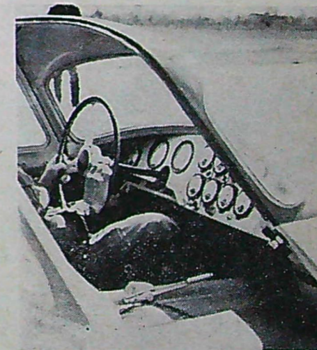
Gasturbinbilens instrumentpanel är fylld av olika instrument, som inte återfinns på kolvmotornas bilar.
