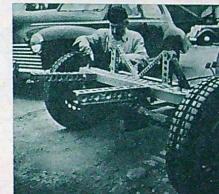
Fjädringen på fartåket är en viktig detalj. Den kan ställas om efter banans egenskaper genom vingmuttrarna på bakaxeln.
