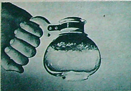
Ju lägre lufttryck ju lägre kokpunkt. Det är den enkla principen som ligger till grund för det effektfulla tricket att koka kaffe på is.
