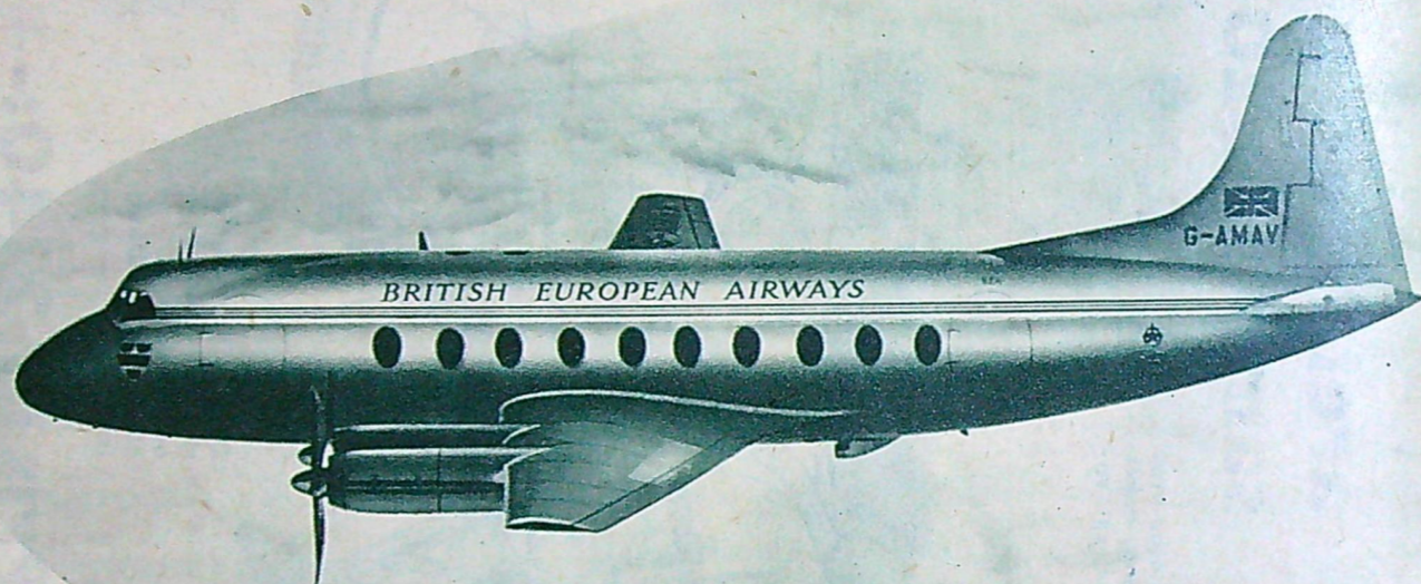
Vickers Viscount. Fyra Rolls-Royce »Dart» motorer.
