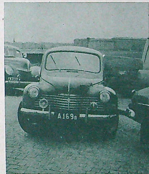
Renault 4 CV är som gjord för storstadstrafik. Vändcirkelns diameter är endast 8,6 meter, vilket möjliggör en utomordentlig parkeringsekvilibristik.
