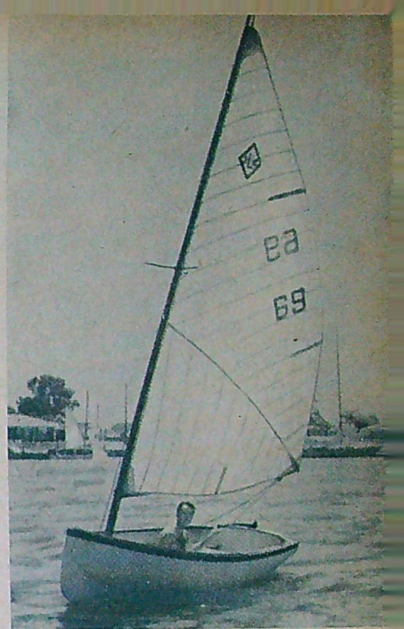
Denna lilla amerikanska jolle är gjord helt i plast. Även masten är av detta material.
