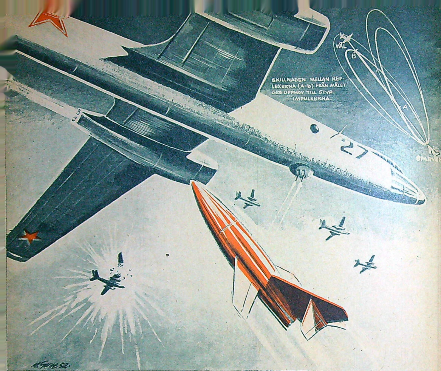
»Sparven» har en räckvidd av 5-6 km och transporteras till närheten av målet av ett moderflygplan. När roboten lämnar flyg-
