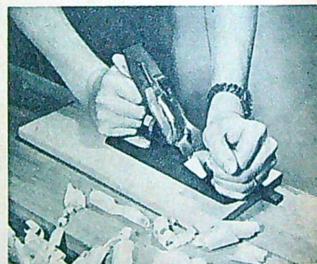
Putsnig. Järnhyvlarna är särskilt bra lämpade för denna procedur. Lätta att ställa in.
