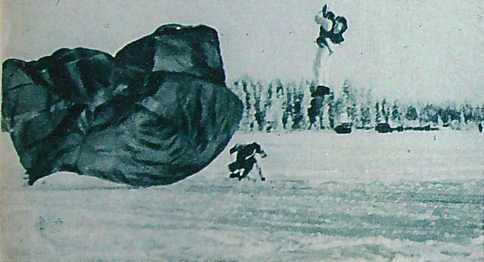
Våra fallskärmsjägare använder svenska Irvin-skärmar. En skärm består av 68 m tyg på 90 cm bredd, varje våd är triangelformad. Sektionerna sys ihop till en triangelformad våd, våderna sys samman intill varandra så att skärmen när den ligger på marken är cirkelrund.
