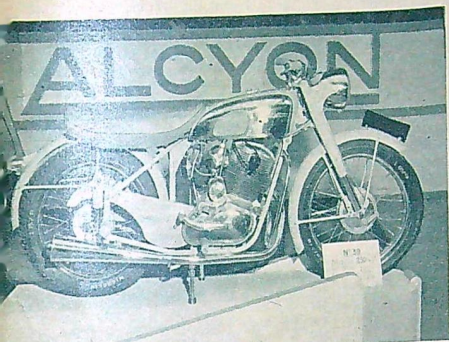
Alcyon är en av de franska motocyklar som utrustats med 250 cm 3 AMC-motor. Cylindrarna i rad, vevaxeln i maskinens längdriktning.
