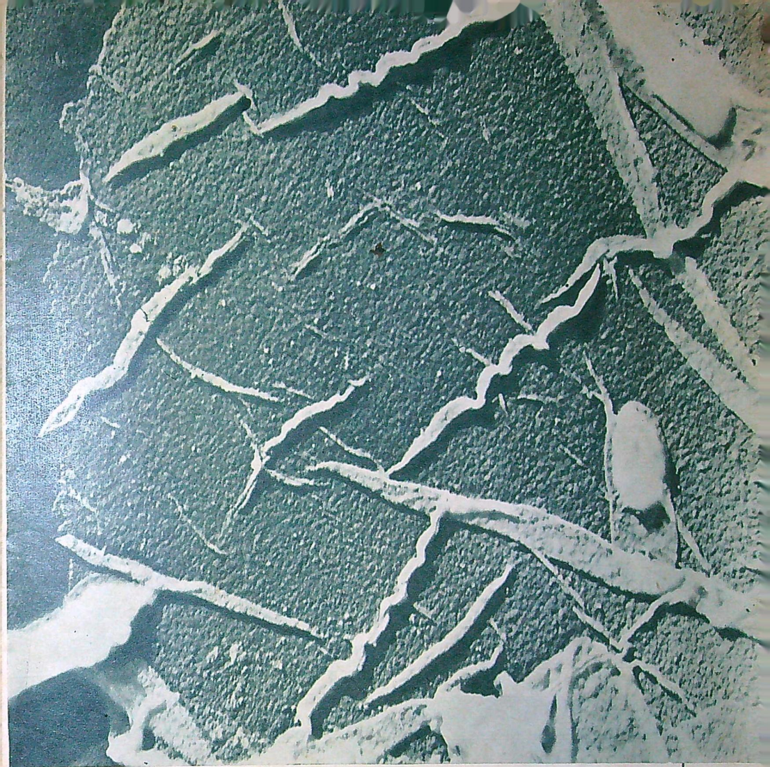
Den tunna ythinnan, den s. k. epikutikulan, hos ull ser i cirka 35.000 ggr förstoring ut så här. Det ovala föremålet t. h. är en bakterie av fömligen normal storlek. Hinnan, vars gräns synes till vänster är inte mer än några få miljondels millimeter tjock. Elektronmikrografi från Textilforskningsinstitutet.
