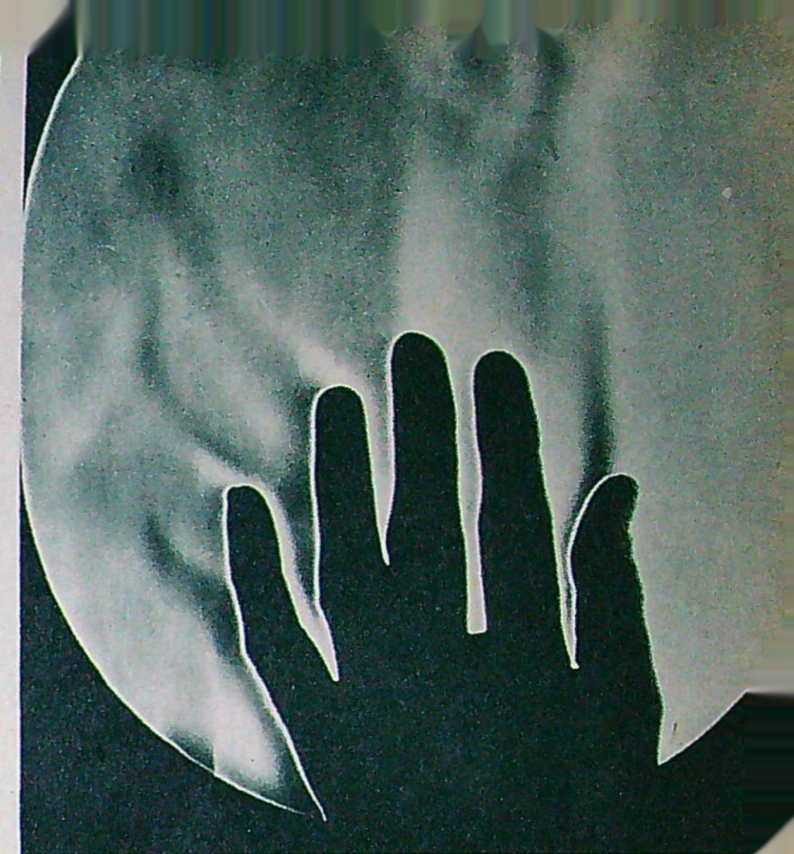
Så här ser det ut runt er hand. Det är de varma luftströmmarna som har fotograferats. Den av handen uppvärmda luften blir lättare än den omgivande och skapar på så sätt en temperaturfördelning.
