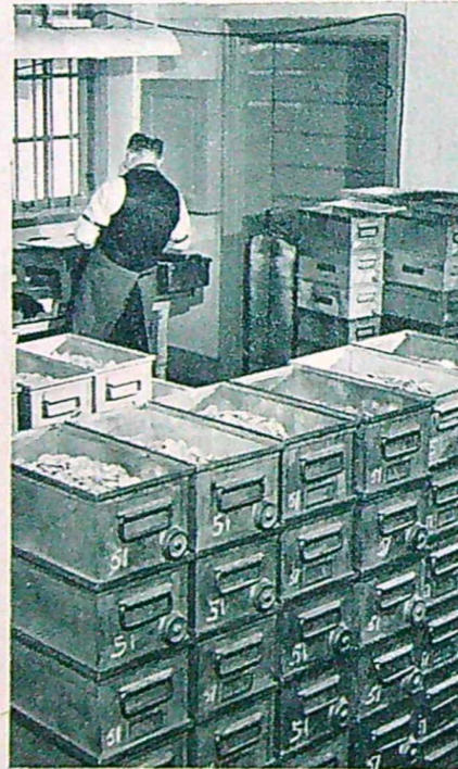
Nej, det är ingen gammal skattgömma. Rensningen är dock viktig nog. Före präglingsen kasseras en del plattor och smälts om igen.
