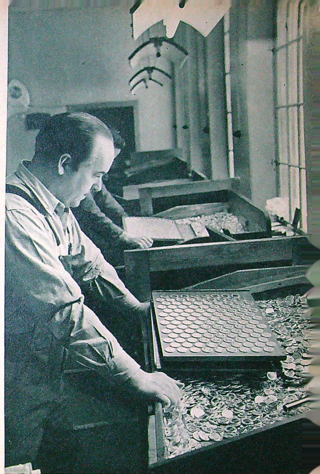
Massor av pengar! Vi är framme vid slutresultatet. På en plåt som rymmer 126 tvåkronor synar och räknar Sture Karlsson de färdiga mynten. Sedan återstår inte annat än att räkna in pengarna i påsar som förseglas och lådor, och så bär det av till banken med rikedom!
