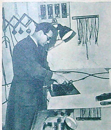
4 Laborant Erik Löfgren i arbete med en plåt på vilken rättelser skall göras. Kopparen fälls ut på elektrolytisk väg inom det område som skall rättas. Man arbetar med svagström och på 15 timmar är det klart.
