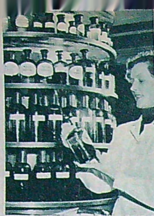
2 Där tar fröken Ulla Schulzberg hand om det. På en roterande hylla, vars kapacitet motsvarar 24 hyllmeter rak hylla hittar hon de rätta ingredienserna som vägs upp mycket noga.
