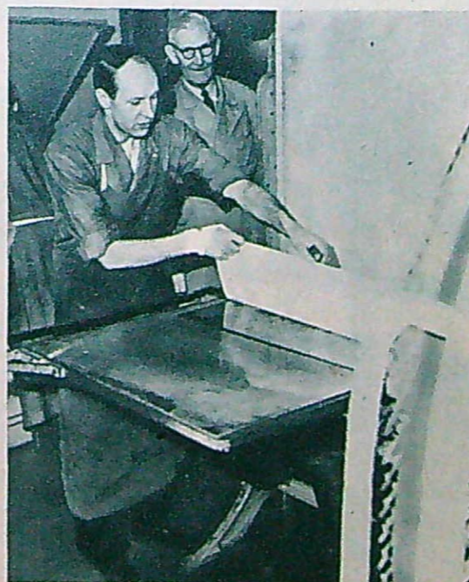
7 Koppartryckare Valfrid Nordlöf drar av ett ark. Sedan plåten torkats läggs den på ett fundament. Det tomma arket läggs på en dekel med stampad filtt, ett ex. är klart.
