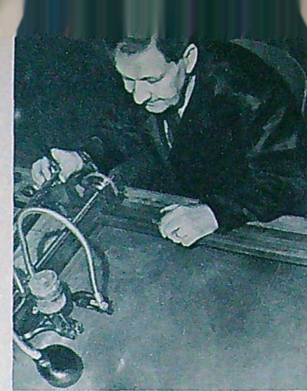
2 Att gravera kopparplåt som används vid all sjökortstrykning kan ta flera år. Här håller förste gravör K. E. Forsberg på med en detalj i en s. k. landtonsmaskin, där den mörkare landfärgen läggs på och en s. k. rulett arbetar över plåten. Det behövs tålmod.
