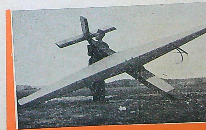
För att göra målbogseringen mera realistisk har man numera frångått de tidigare "korvarna" och i stället gått in för s. k. vingmål av den här typen.
