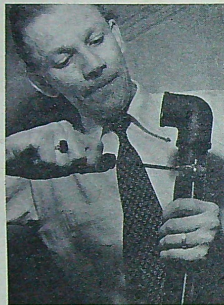
Flexibelt rör av vinylharts. Genom sin böjlighet kan detta rör användas på ställen där stela rör ställer till svårigheter. Det har stor motståndskraft mot korroderande vätskor och angrips inte heller av bensin.
