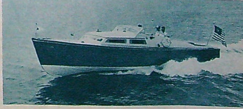
Se här en snygg båt som inte skulle behöva bli dyr om den klink byggdes i furu på ett svenskt varv. Den amerikanska modellen är 10,6 m och drivs av en Packard Marlinmotor. Inredningen består av en rymlig ruff med fyra sovsplatsar, kök med kylskåp, diskbänksplis och alla bekvämligheter, toalett, elektriskt kraftverk o.
