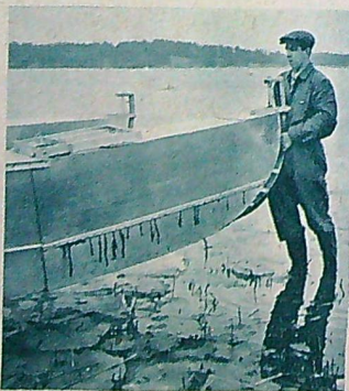
För att kunna parera stötararna mot isen och ev. grynnor har stivarna gjorts lösa och försetts med extra skofångare långt fram.
