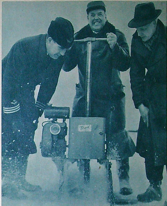
Meteorolog S. H. Gagge i flygväpnet och Ingenjör H. Moberg från meteorologiska byrån ser på när brandmästare K. A. Gustafsson borrar i igenom 70 cm tjockt is. Det är gjort på knappt 20 sekunder med största skåret. — T. v. sitter motorn med bensintank och t. h. frikopplingshandtaget. 2.500 kr kostar denna praktiska maskin.
