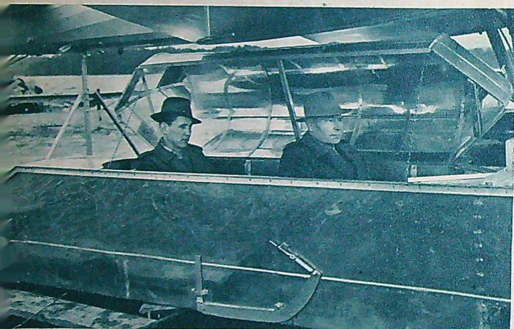
Dessa pontoner är byggda för två passagerare i varje, men i en konstruktion under byggnad är det meningen att få plats med sammanlagt 24 passagerare. Nedtill syns det viktiga slirskyddet, som inställs en gång och är det enda som styr farkosten vid 150 km fart.
