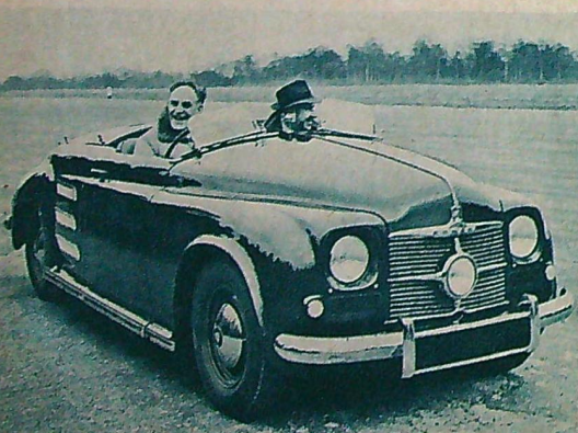
T. v.: Luftintagen framför bukskärmmarna och avkasthålen bakom försättsen är de enda yttre skillnaderna mellan en vanlig Rover 75:a och turbo-Rover. — T. h.: I en kolvmotor (nedre delbilden) sker arbetstakterna i tidföljd efter varandra (nått en och samma cylinder. I turbomotor (övre delbilden) sker arbetstakterna
