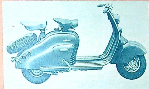
Den italienska Lambretta-scootern har försetts med en skaross i stål med Vespan. Den övriga konstruktionen är oförändrad.
