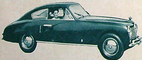
Ett överraskande nytt Fiatansikte. En av expons flottaste sportvagnar var Fiat 1100/8 med en specialkaross ritad av Pinin Farina. En upptrimmad Flatmotor ger 51 hk. Ny oljekylning, Bl. a. tack vare lättmetallkaross — vjnröd med metallglans — är vikten endast 825 kg.
