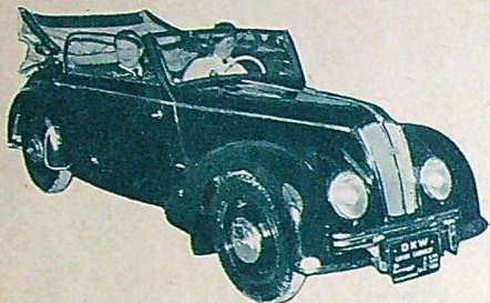
DKW uppenbarar sig i en stålkaross av helt nytt slutt. Data är i övrigt desamma som för förkrigsårens modell (fast stötdämparna nu har fjädrings teleskopiska). Bilen är alltså utrustad med en 2-cyl. 2-taktsmotor på 20 hästkrafter och cylindervolymen är 684 cm 3 .
