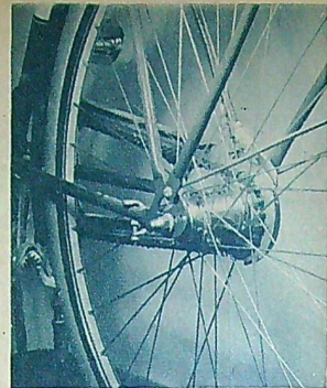
Den nya växeln ser ut som en vanlig expanderbroms och monteras direkt på frinavet.
