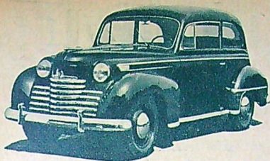
Nya Opel Olympia från tyska General Motors, 1936 års modell uppvisar en helt ny växelåda med tre växlar mot tidigare fyra och dessutom rattväxel. Ny s. k. parallelltogramfjädring framtill. Karossen har genomgått en sänkskiftning.
