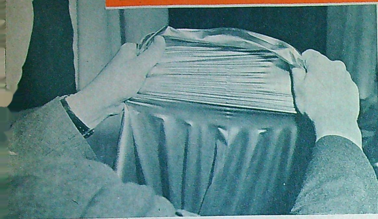
Att sömnen, dvs fogen, blir både vattentät och lufttät och lika stark som materialet i sig själv, visar disponent C. G. Karlström vid konfektionsfabriken KASY i Stockholm.
