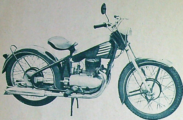
Så här skall en svensk bruksmaskin se ut enligt verkmästare HARRY CARLSSON på Motor-Service i Stockholm. Tvåtaktsmotorn är på 250 cm 3 och ger toppfarten ca 100 km/t.
