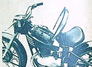
Bensinkran, verktyg, tändstift och påfyllningshål ligger dolda under en aluminiumkåpa som kan lösas. Elegant och effektivt.
