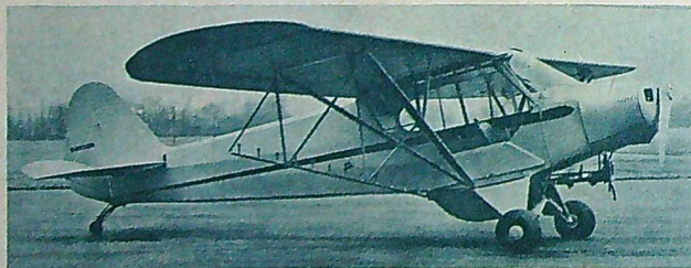
Piper Cub Special med besprutningsaggregat och långa vätskespidare under vingarna.
