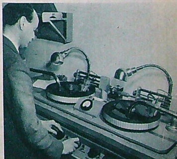
På 78 varvs lackskivor, speltid 2 min., sker de flesta inspelningarna. Ing. C. A. Jacobson spelar in »Eko!» för kvällens sändning.
