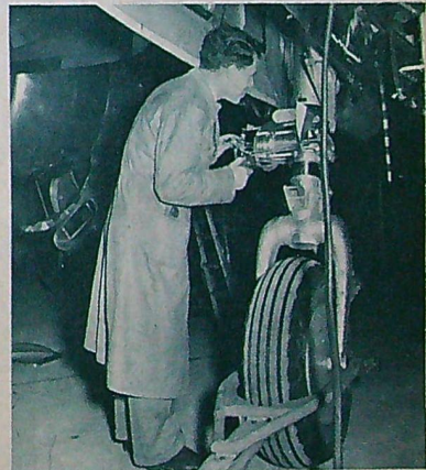
GÖSTA ANDERSSON , som är SAS kontrollant vid Saab, undersöker styrcylindern till noshjulet som är Saabs egen konstruktion.
