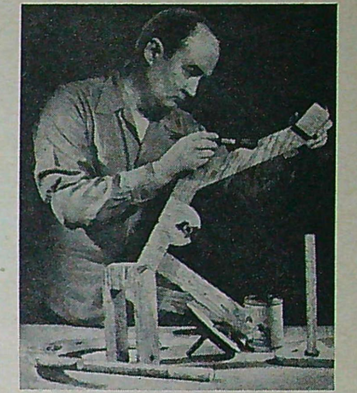
När ramdelarna hoplimmas ska de strykas med ett lager schellack eller fennissa.
