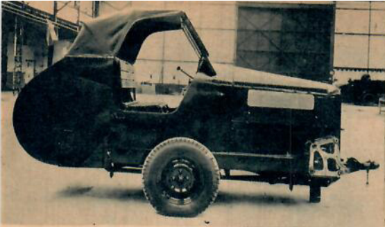
Vinschen från sidan. Under apparaten syns tydligt bryggan som vinschen vilar på i arbetsställning.
