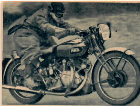
Sadeln möjliggör två körställningar, en för vanlig körning och en för »racing», som på bilden ovan.
