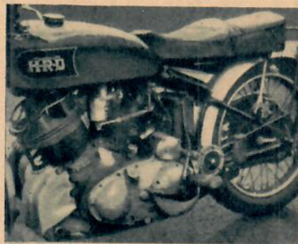
Ingen ram, en motor på nära 1000 cc, en toppfart på 180 km/tim., fyra bromsar — se där några av finesserna på H.R.D.
