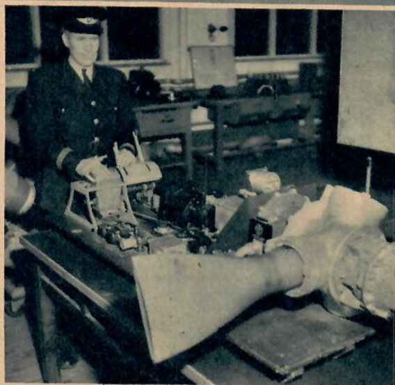
T. v.: »Körbara» atrapp av den reversibla elektriska Curtisspropellern. Anordningen som omfattar samtliga reglage, instrument och apparatur som finns på flygplanet provas här av startmästare SIGURD MALM. — T. h.: Så här kommer den s. k. flygplundocken att se ut när den vid översyner monteras kring DC-6:orna.
