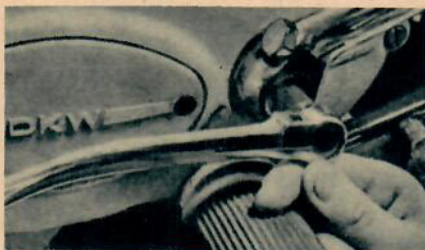
Justering av fotväxelpedalen på DKW.
