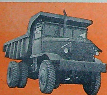
På vinjettpildern. Harsprånget i sommarskrud — snart ett minne blott. Därunder det vackra egnahemsområdet. — T. v. sprängstenen från tunnarna fraktas med specialbyggda 12-tonns lastbilar.
